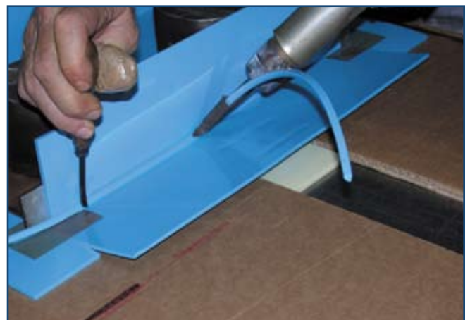
Stabschweißen von Profilen
