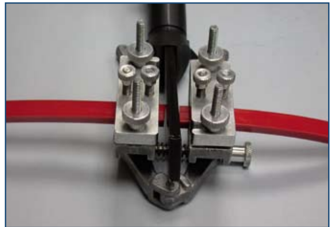
F-51 Zange für standardmäßige Keil- und Rundriemen
